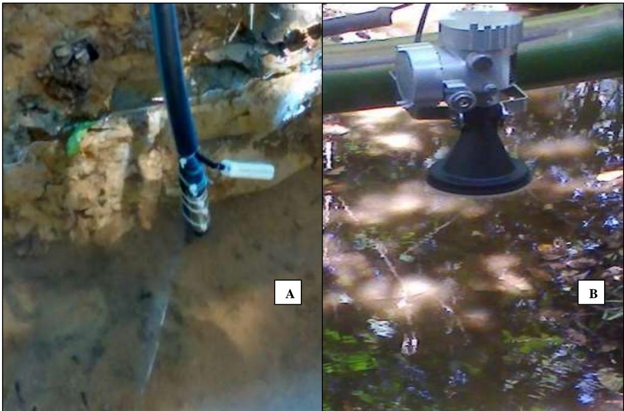
**Figura 3:** Sensores de turbidez, temperatura, condutividade elétrica e nível da água. (A) Sensores de turbidez, temperatura e condutividade elétrica dentro do curso d'água. (B) Sensor de nível d'água.
