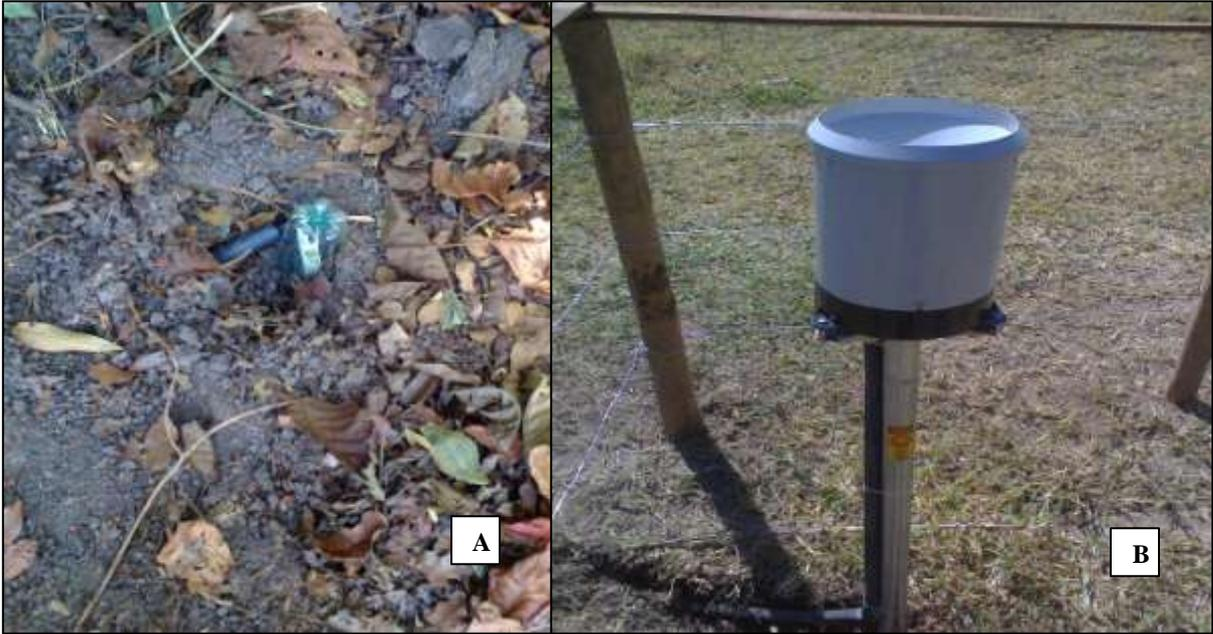
**Figura 4:** Sensor de umidade do solo (A) e pluviômetro (B).
